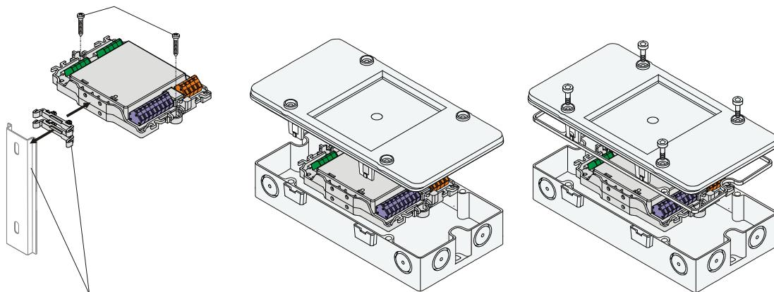
Ulazni-izlazni modul **Siemens Sinteso™ FDCI222** omogućava nadzor beznaponskim kontaktom kao što su: kontakti PP vrata, stanje sprinkler ventila itd. i upravljanje PP vratima, ventilacijom, odimljavanjem, isključenje električne energije i sl.
